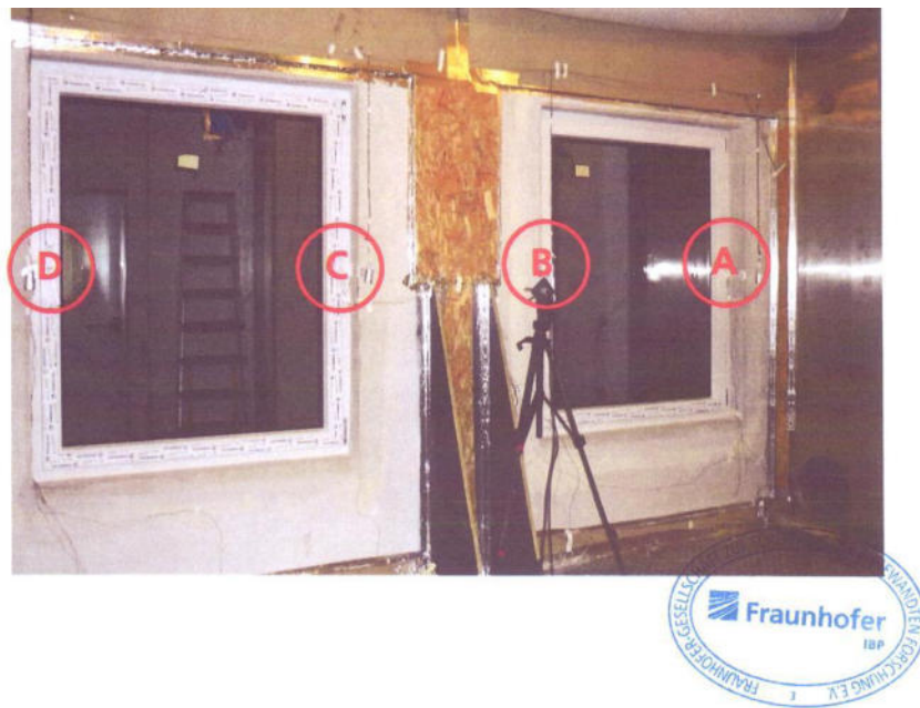
Bild 3: Ansicht der kompletten Fassade mit Außenwand und den beiden vollständig eingebauten Fenstern im Dreikammer-Klimasimulator am Fraunhofer IBP in Stuttgart. Aufnahme von der Warmseite her, direkt vor Versuchsbeginn. Die Bezeichnungen A, B, C und D markieren die jeweilige Fugenausführungsart. Fugen A und C sind mit Dow ausgeführt, B und D mit herkömmlicher Fugenausführung (»Standard«).
