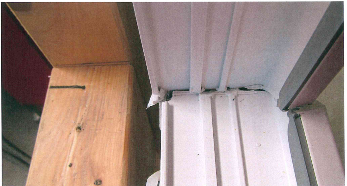
Bild A.4.2: Innenansicht, Bruch des Fensterrahmens am oberen linken Rand nach einer Pendelfallhöhe von \Delta h = 900 mm
