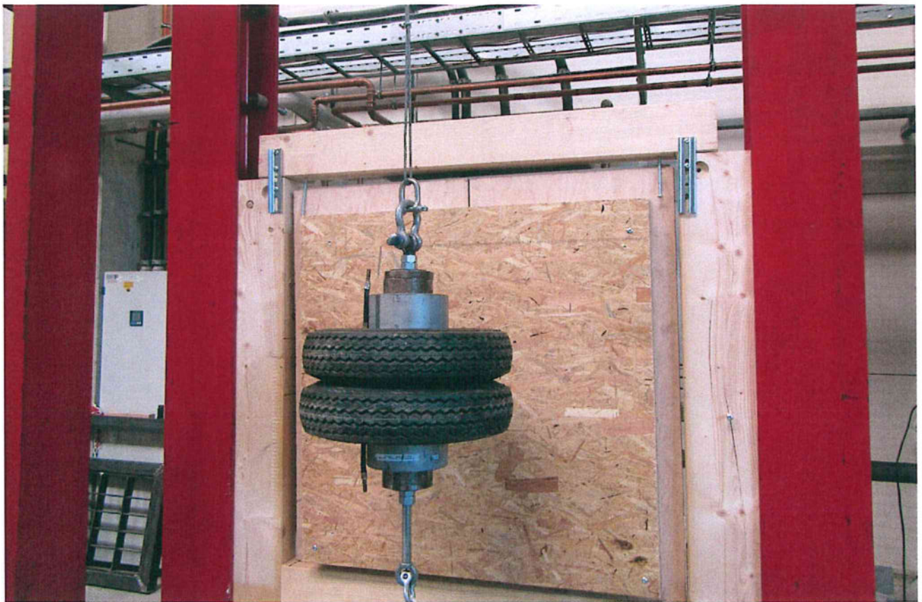
Bild 1: Pendelschlagversuch auf die Füllung. Ersatzweise ist für die Verglasung eine d = 20 \text{ mm} starke Sperrholzplatte montiert worden. Der Pendelschlag wird auf die Sperrholzplatte durchgeführt
