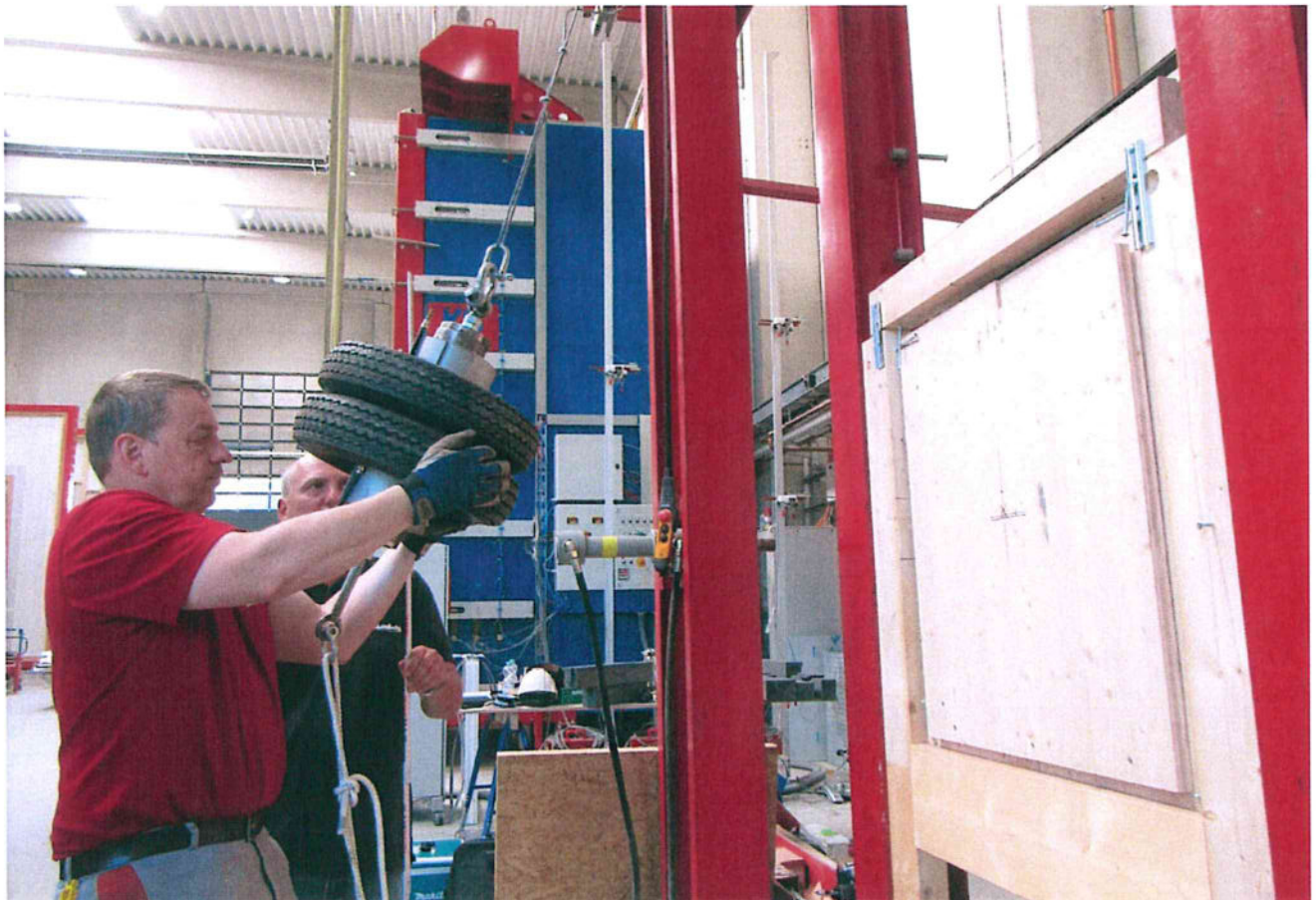
Bild A.6.2: Pendelschlagprüfung. Nachprüfung mit einer Pendelfallhöhe von \Delta h = 100 mm. Nach dem Pendelschlagtest mit einer Pendelfallhöhe von \Delta h = 900 mm waren Beschädigungen oben am Rahmen und oben am Befestigungspunkt aufgetreten. Daher musste ein zusätzlicher Pendelschlagtest mit \Delta h = 100 mm auf die Konstruktion durchgeführt werden
