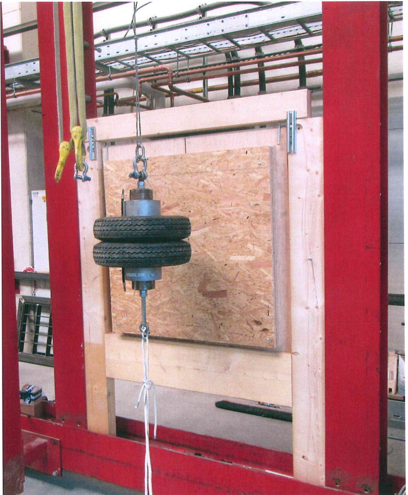
Bild A.3: Versuchsvorbereitung, der Pendelschlagkörper ist auf die Auftreffstellen Nr. 3 ausgerichtet. Der Fensterrahmen ist in den Prüfstand eingebaut. Eine Sperrholzplatte dient als Füllung für die Verglasung
