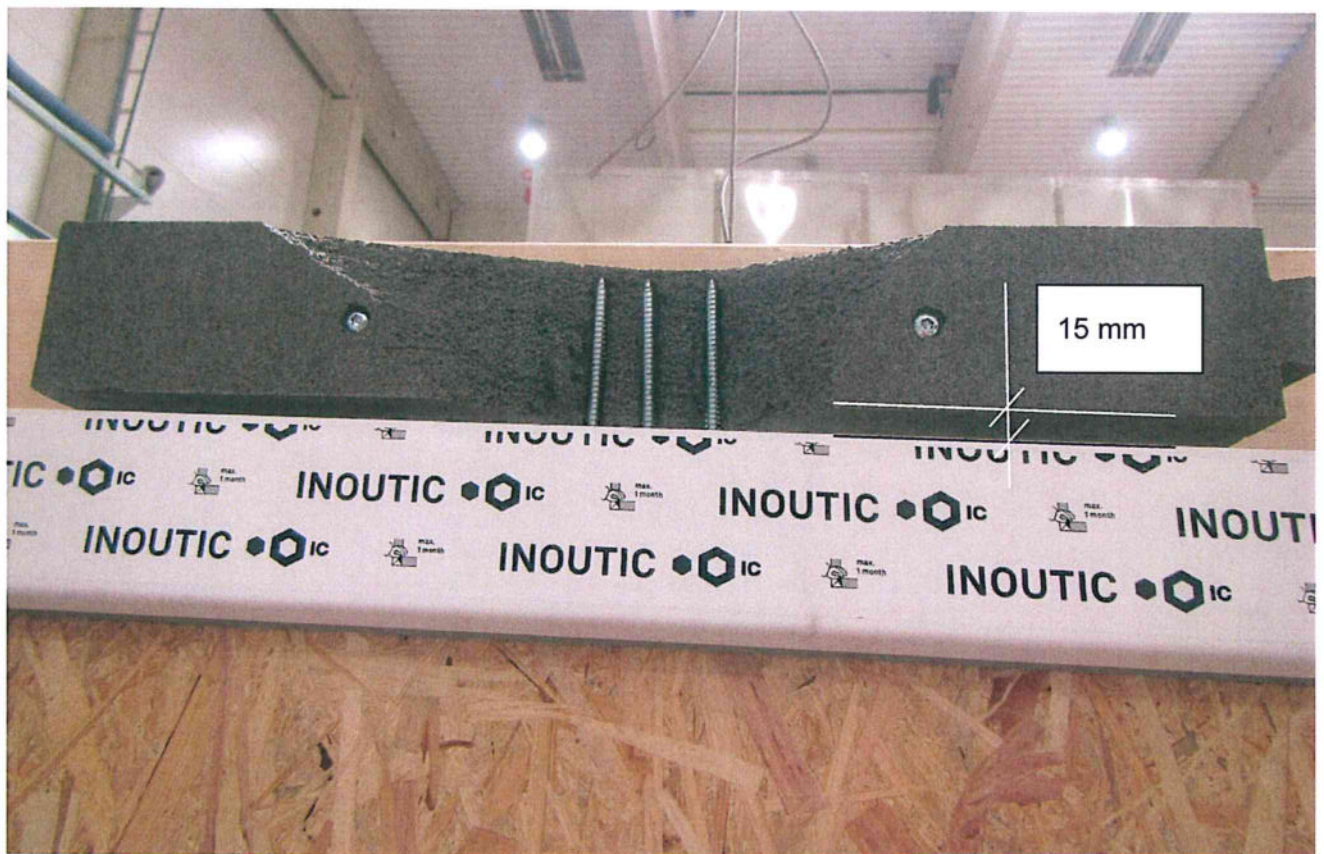
Bild A.5.1: Bruch des Befestigungspunktes im blaugelb Triothem+ am oberen Rand nach einer Pendelfallhöhe von \Delta h = 900 mm. Die Beschädigung trat nach dem Pendelschlagtest mit \Delta h = 900 mm auf
