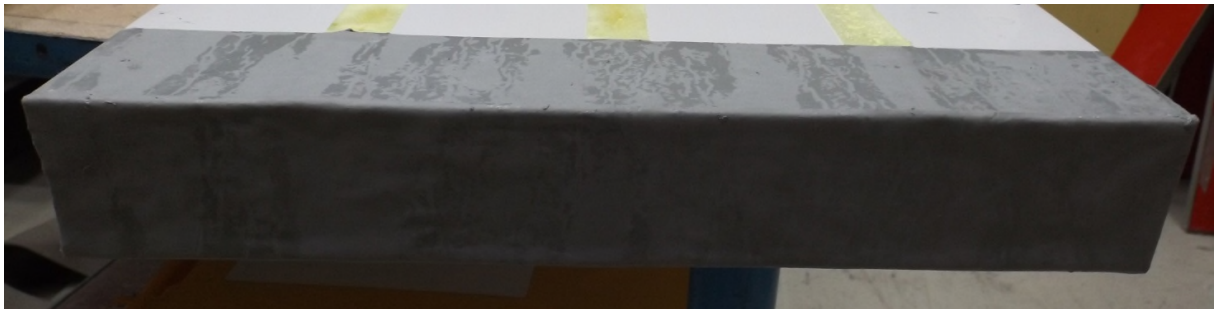
Bild 4: Ausgleich der Unebenheiten und zusätzliche Abdichtung mit Butylband.
