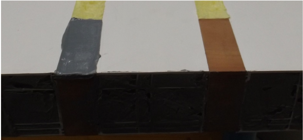
Bild 3: Füllen der Hohlprofile mit Silikon und Abdichtung der Abstandsklötze aus Buche mit Butylband.
